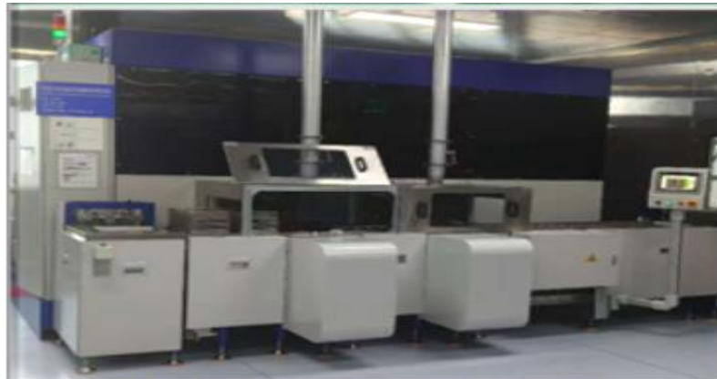
2腔室真空超声波溶剂型清洗线
